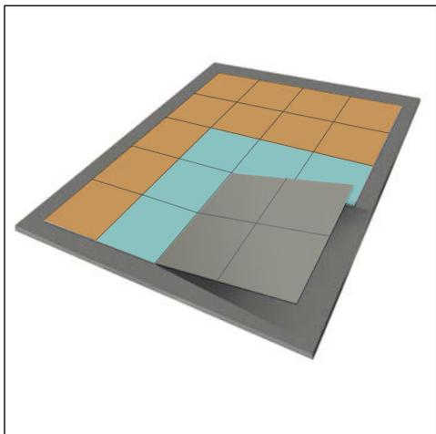
Retourner les quatre carreaux et les replacer dans le coin.
