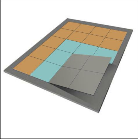
Voltee los cuatro módulos boca arriba y reposicione las esquinas de las alfombras.
