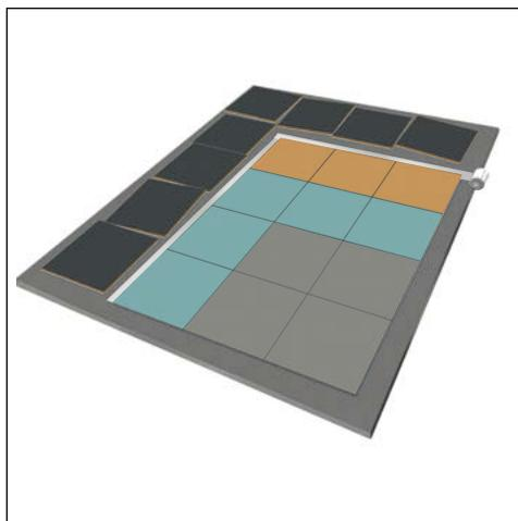
Comece substituindo as placas previamente viradas, conectando o verso das placas à fita com a metade exposta. Comece pela borda externa.
