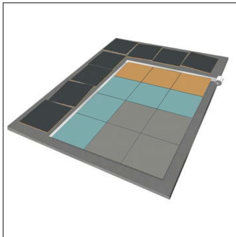
Empiece a reemplazar los módulos previamente volteados, conectando su parte posterior con la cinta expuesta a medias. Empiece en el borde exterior
