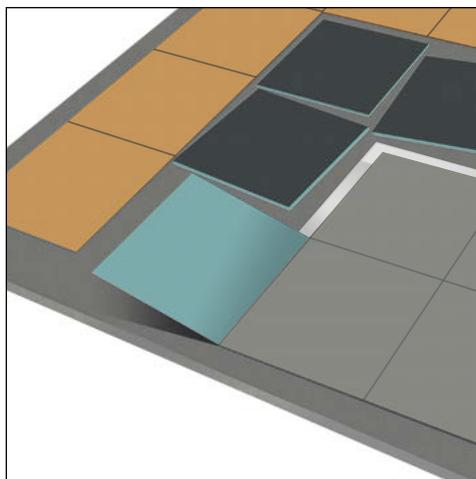
Vire todas as placas adjacentes às placas de ancoragem com o verso voltado para cima. Afaste-as das placas de ancoragem para ter espaço para a aplicação das fitas.
