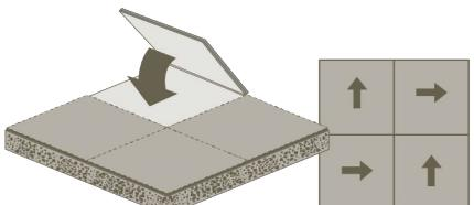
Durante la instalación, rote los módulos para que las flechas estén giradas en 90 grados con respecto al otro módulo.
