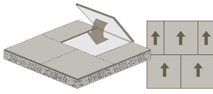
Décalez les joints latéraux des carreaux, tout en orientant les flèches dans la même direction.
