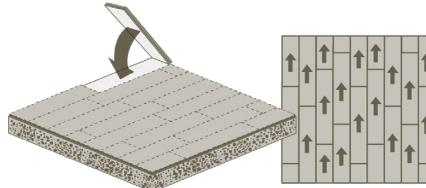
Desloque as juntas dianteiras e traseiras da placa. Recomendamos um ashlar com recuo variável para nossas Skinny Planks, como mostrado aqui, mas nossos produtos também podem ser instalados com um ashlar de meio recuo.
