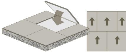
Desloque as juntas laterais das placas com as setas voltadas para a mesma direção.
