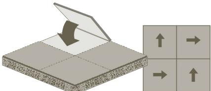
Durante a instalação, gire as placas de modo que as setas sejam giradas em 90 graus intercalando as placas.
