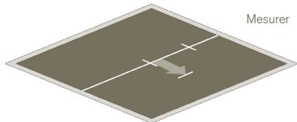
3. À partir du point central, mesurez 182,9 cm (6 pi) perpendiculairement à la ligne et faites une marque.
