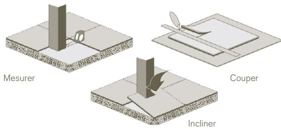
Il faut couper les carreaux adjacents aux accessoires fixes, aux éléments d'architecture et aux murs. Voici quelques principes à suivre :
