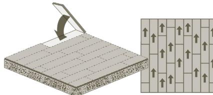
Compense las juntas de los módulos frontal y posterior. Recomendamos una variable de sillería de caída, como se muestra en la imagen, pero nuestros productos también se pueden instalar con sillería de media caída.
