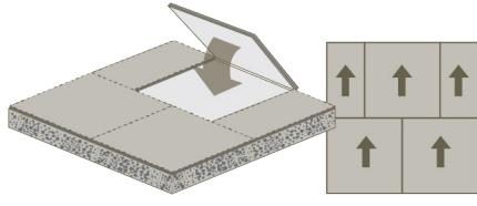
Compense las juntas de los módulos laterales con las flechas en la misma dirección.
