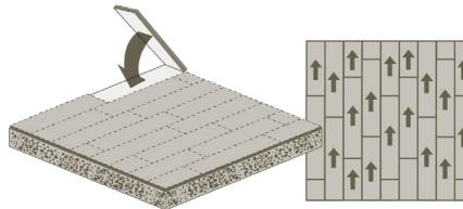
Décalez les joints avant et arrière des carreaux. Pour nos planches étroites, nous recommandons un motif de pierres de taille à décalage variable, comme illustré ici, mais l'installation avec décalage à la moitié est aussi possible.
