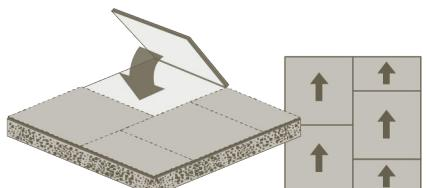
Desloque as juntas dianteiras e traseiras das placas com as setas voltadas para a mesma direção.
