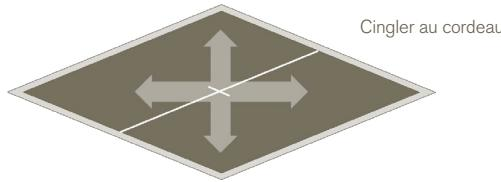
1. Mesurez la surface afin d'en déterminer le centre et faites-y une marque. Cinglez une ligne de craie au moyen du cordeau.
