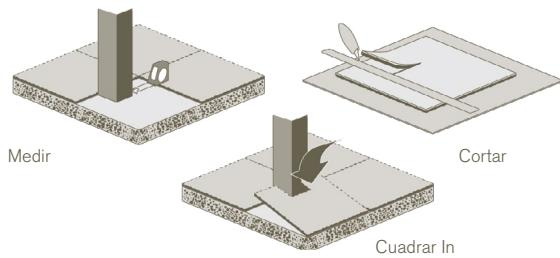
Los módulos adyacentes a equipos, elementos arquitectónicos y paredes deben ser cortados. Siga estas directivas:
