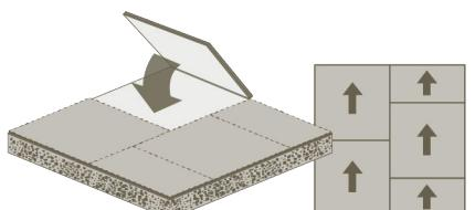
Compense las juntas de los módulos frontal y posterior con flechas en la misma dirección.
