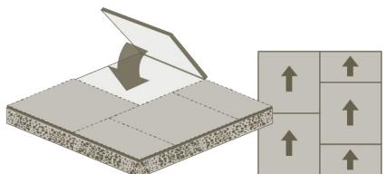
Décalez les joints avant et arrière des carreaux, tout en orientant les flèches dans la même direction.
