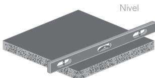
Método de referencia de borde recto de 3 m (10 ft). El nivel se define como una separación máxima de 0.64 cm (1/4 in) en el 90 % de las muestras tomadas. Ninguna muestra debe exceder una separación máxima de 0.95 cm (3/8 in).
